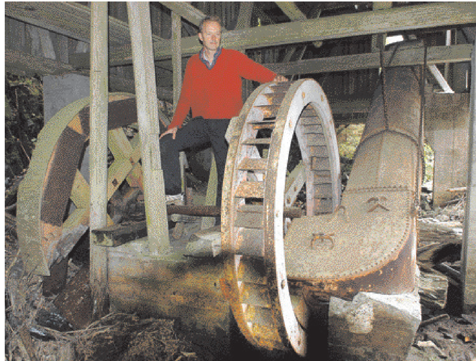
Nils Borge står med beinet på akselen til den gamle gårdssaga, som bestefaren hans bygde om fra oppgangssag til sirkelsag i 1925. Røret til høyre i bildet fikk tilførsel av vann fra ei trerenne som ledet vannet inn. På enden av røret er det ei innsnevring som gjorde at vannet traff skovlehjulet med stor kraft. Akselen forbinder skovlehjulet med reimhjulet til venstre i bildet. Reimhjulet var forbundet med sagbladet med ei bred reim.
