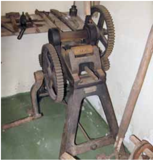
Bukkemaskin på Bygdemuseet på Borge. Ble brukt til å bøye jernbeslag til vognhjul. Foto: Arve Hoven.
